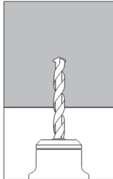
Percer le support béton à Ø5x70 mm
