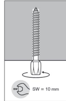
Visser à l'aide d'une clef ou douille SW = 10 mm
